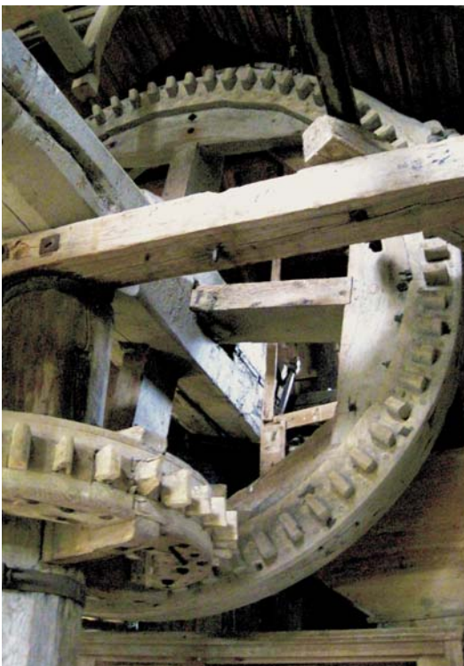
2 – BOVENWIEL MET DOORGESTOKEN KRUISARMEN IN DE PALTROKMOLEN VAN POSADA.
